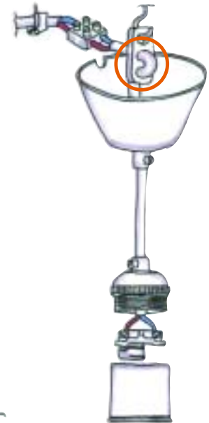
Tilkobling av lamper
